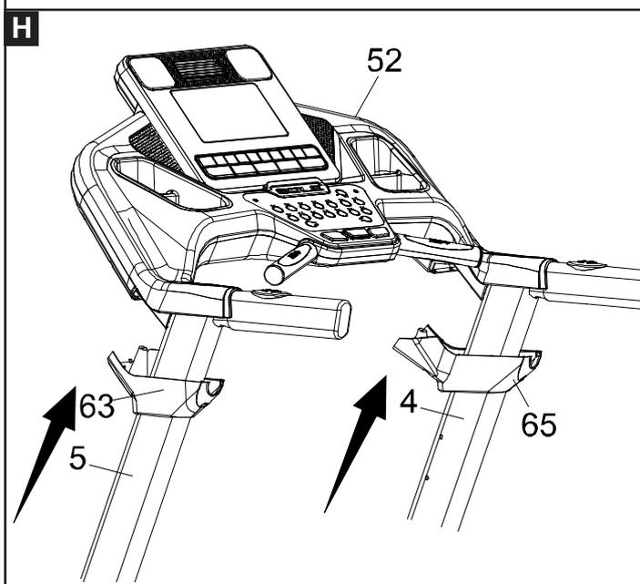
**I.** Fissare i coperchi sulle estremità dei montanti serrando dalla parte inferiore di ciascuno tre viti filettate **168** [ST3,5x12 mm], facendo riferimento all'illustrazione a lato; impiegare il giravite nella chiave **131** fornita in dotazione.
