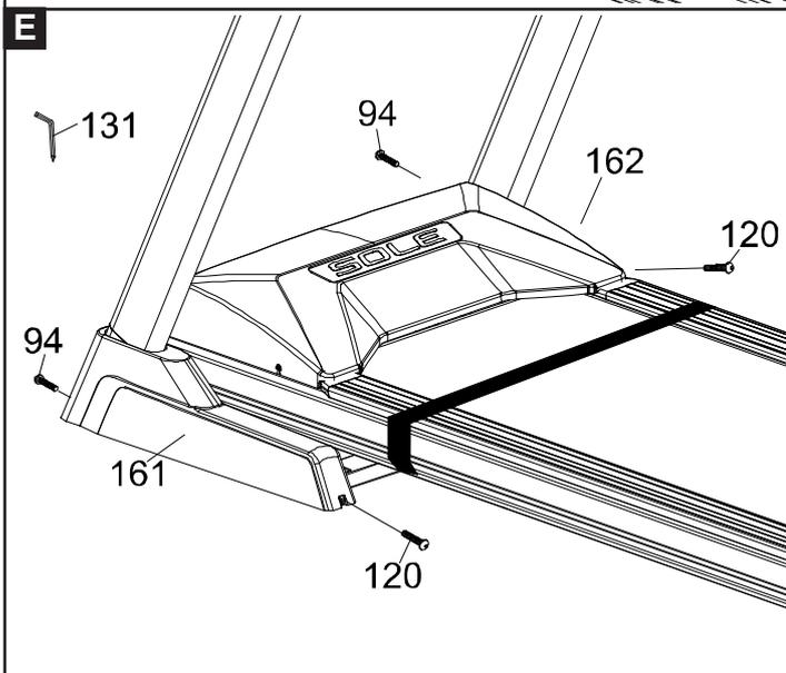
**E.** Abbassare i rivestimenti copri-montante **161** e **162** e posizzarli allineandole ai fori di fissaggio delle clips. Fissare ciascun rivestimento serrando nei fori predisposti una vite **120** [Ø5 × 16 mm] e una vite **94** [M5x20 mm]; impiegare il giravite **131**.
