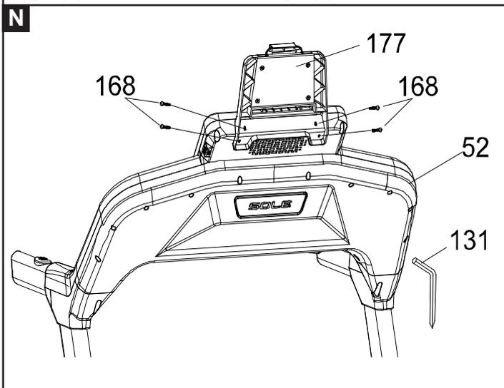
**N.** Fissare il supporto tablet **177** nell'estremità della plancia **52** serrando quattro viti autofilettanti **168** [ST3,5x16 mm]; impiegare il giravite nella chiave **131**.
